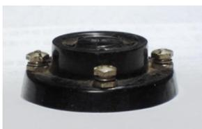
球のソケットは、写真のように平面に取り付けられる構造で、周りに裸のターミナルが並ぶ物であった。トップの電線の金具を抜いて無造作に置いたらしい。フィラメントの+端子に当たったようであった。
